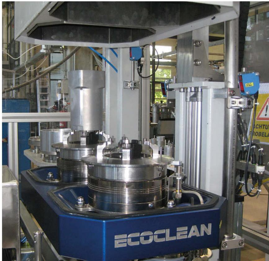
**Bild 3:** Trockenreinigungsverfahren wie z. B. die Vakuum-Luftreinigung lassen sich in Montagelinien integrieren und zur Entpulverung additiv gefertigter Teile einsetzen.
