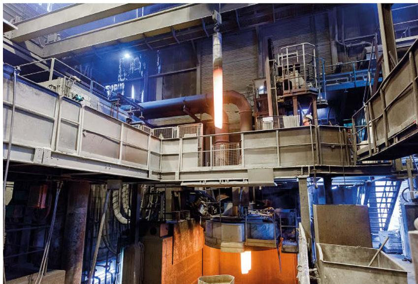
**Bild 1:** Bei der Sekundärstahlherstellung wird Stahlschrott aufgeschmolzen und zu neuem Rohstahl verarbeitet.
