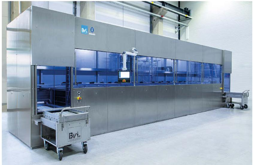
Die modulare Mehrkammer-Tauchanlage Atlantic.
