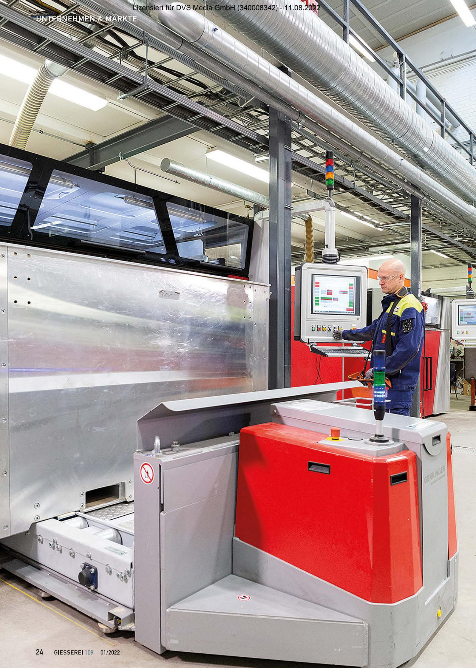
Die VX2000 ist der zweitgrößte 3-D-Drucker im voxeljet-Portfolio. Nach einem neuen Update druckt das System eine volle Jobbox von 2 x 1 x 1 Metern in knapp 24 Stunden.
