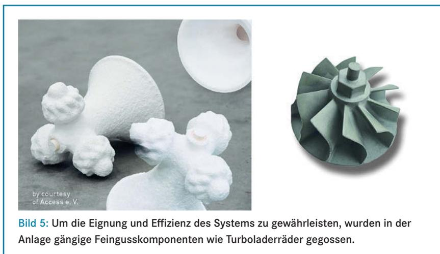
**Bild 5:** Um die Eignung und Effizienz des Systems zu gewährleisten, wurden in der Anlage gängige Feingusskomponenten wie Turboladerräder gegossen.
