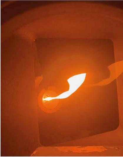
**Bild 1:** Der Gießprozess in der Zweikammer-Vakuummießanlage.
