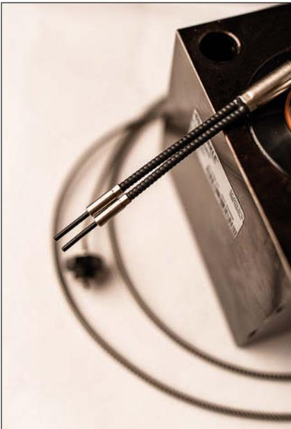
**Bild 1:** Mithilfe von Lichtleitern lässt sich die temperaturempfindliche Elektronik effektiv vom Messpunkt absetzen.
