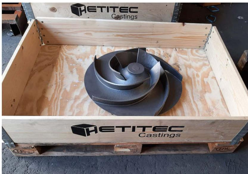
Bauteile wie dieses Laufrad aus Duplexstahl kann Hetitec innerhalb weniger Tage montagefertig ausliefern. Besonders, wenn schnell ein Ersatzteil benötigt wird, eine enorme Zeitersparnis gegenüber konventionellen Fertigungsmethoden.
