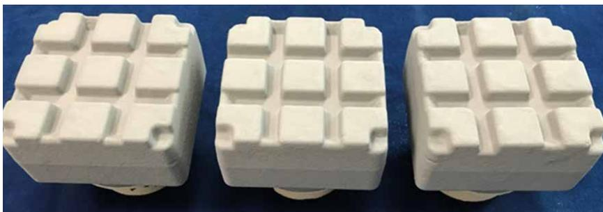
**Bild 12:** Sandkerne mit einer durch Tauchen aufgetragenen Beschichtung. Die Schlichte wurde 1 Stunde lang bei 120 °C im Ofen getrocknet.
