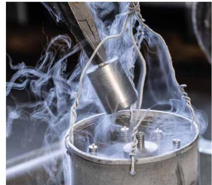
**Bild 5:** Vor dem Einsatz muss man einen Schrumpfstopfen mit flüssigem Stickstoff auf -196 °C abkühlen, den Formeinsetz als Gegenstück hingegen auf 350 °C erhitzen.
