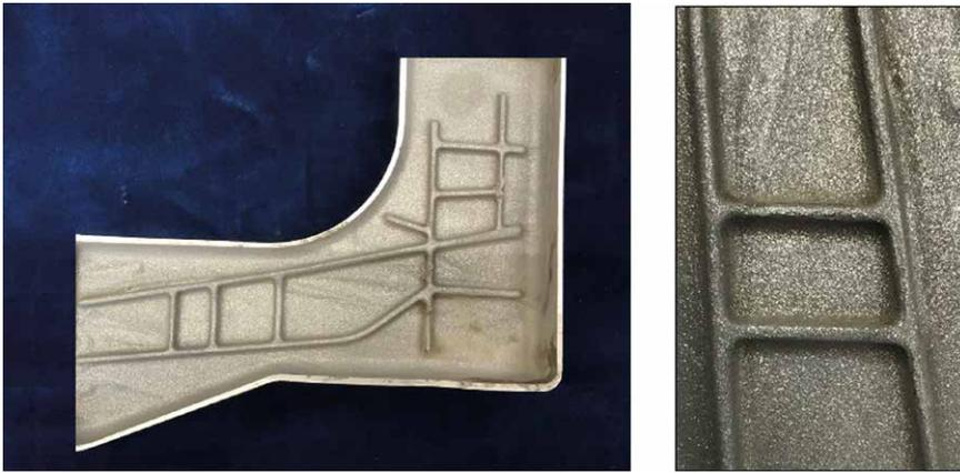
Bild 16: Die Innenfläche der Gussstücke nach Reinigung mit einem Hochdruckreiniger.
