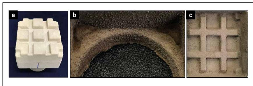
**Bild 11:** a) nicht beschichteter Sandkern; b), c) innere Gussoberfläche mit erheblicher Sandanhaftung.
