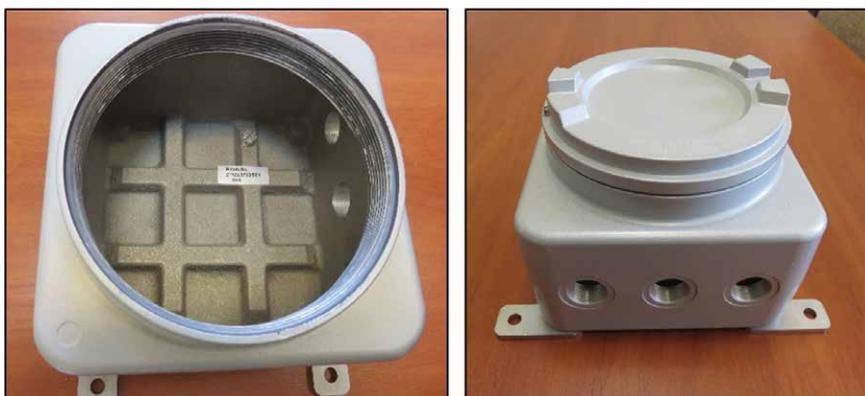
**Bild 13:** Innenseite des Gussteils (explosionssgeschütztes Instrumentengehäuse) nach Entfernung des beschichteten Sandkerns (mit freundlicher Genehmigung von Limatherm S.A. Polen).
