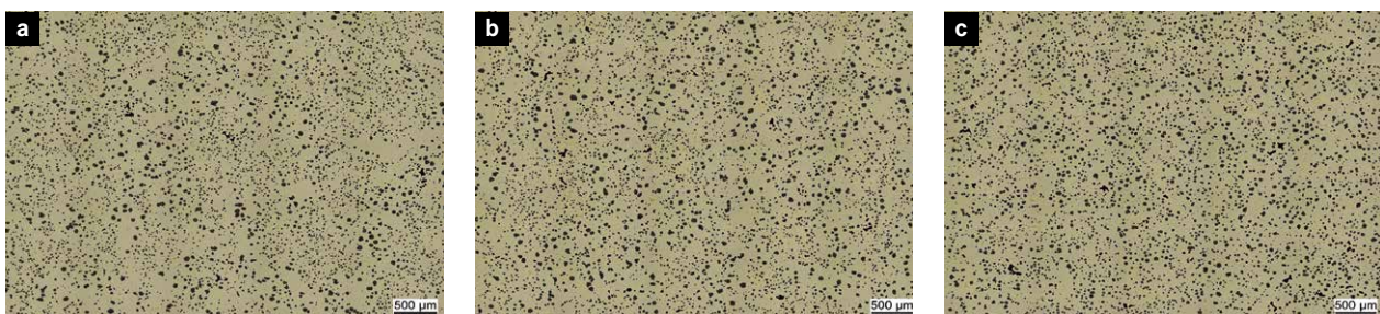
Bild 4: Gefüge eines GJS-Kreislaufmaterials nach dem Glühen bei 1100 °C nach einer Haltezeit von a) 5 min, b) 10 min, c) 15 min.
