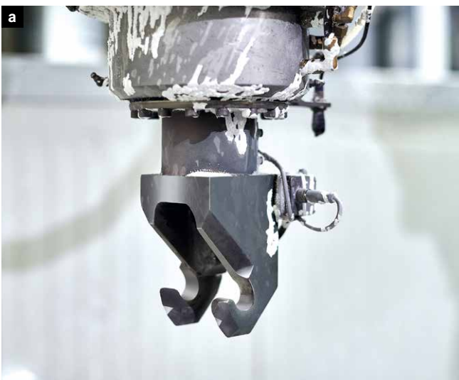
Der Greifer des Roboters (a) mit dem nachträglich installierten Funksensor mittig in der Aufnahme für den Bolzen (b)
