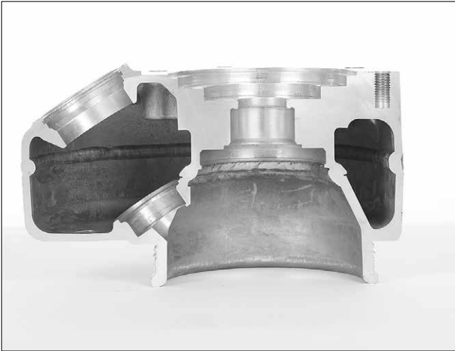
Komplexe Designs mit unterschiedlichen Wandstärken können laut SAG problemlos und in einem Schritt mit der Rheocasting-Technologie gegossen werden. Im Bild: Ein Luftspeicher mit Wandstärkensprüngen und Schweißnähten (l.) und ein Gussknoten (r.)
