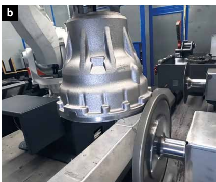
Bild 5: Die extrem kurze Taktzeit ist möglich, weil der Roboter nicht die Werkzeuge zum Werkstück bringt, sondern umgekehrt.
