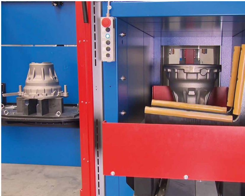
Bild 1: Im Grind Performer werden Eisengussteile ohne spezifische Aufnahme per Rundtisch eingebracht, vollautomatisch von Speisern und Graten befreit und am Ende ausgefördert. Eine Nacharbeit ist nicht mehr erforderlich.
