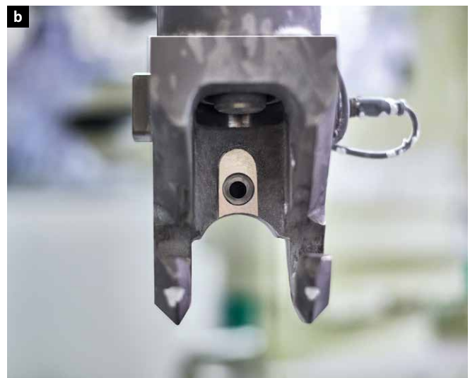
Der Greifer des Roboters (a) mit dem nachträglich installierten Funksensor mittig in der Aufnahme für den Bolzen (b)
