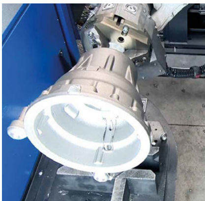
Bild 1: Im Grind Performer werden Eisengussteile ohne spezifische Aufnahme per Rundtisch eingebracht, vollautomatisch von Speisern und Graten befreit und am Ende ausgefördert. Eine Nacharbeit ist nicht mehr erforderlich.
