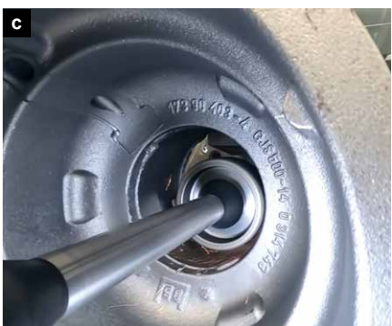
Bild 5: Die extrem kurze Taktzeit ist möglich, weil der Roboter nicht die Werkzeuge zum Werkstück bringt, sondern umgekehrt.
