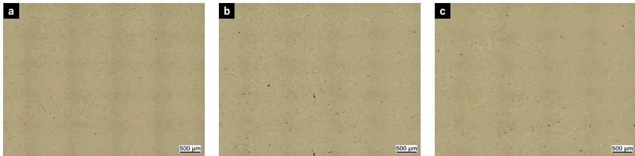
Bild 5: Gefüge eines GJS-Kreislaufmaterials nach dem Glühen bei 1300 °C nach einer Haltezeit von a) 5 min, b) 10 min, c) 15 min.
