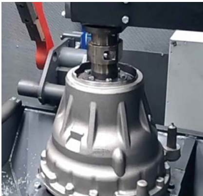
Bild 3: Die Teileerkennung durch Klarschrifterkennung bringt nicht nur Nachvollziehbarkeit, sondern ermöglicht durch formnestspezifische Programmvarianten eine einheitlich hohe Bearbeitungsqualität.
